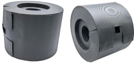
Ces kits sont usinés dans de l'élastomère à cellules fermées afin d'obtenir une très faible conductivité thermique tout en offrant une grande résistance à la diffusion de la vapeur d'eau. Le recouvrement est constitué d'IC CLAD qui offre une excellente protection mécanique. Le système de fermeture auto-agrippant ajustable contribue à épouser parfaitement la pièce à isoler.
